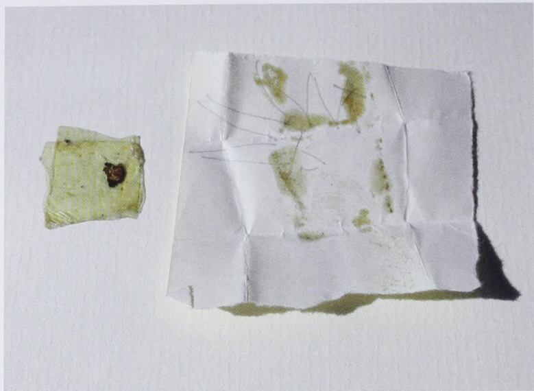
Ill. 32. Arkitekt Erik Findsens dokumentation af indsamlet malingsprøve fra strålekrans på Helios-relief. Prøven blev ved indsamlingen klæbet ind mellem to stykker transparent tape. (Foto: BK ApS)
