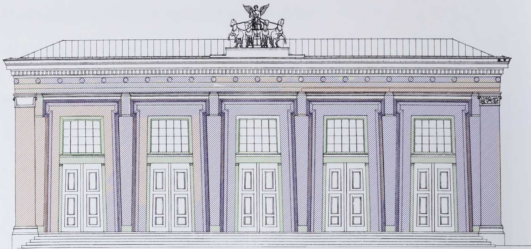
Ill. 7. Bevaringstilstand for hovedfacadens pudsede murflader før restaureringen i 2006. Uddrag af den grafiske tilstandsregistrering.
