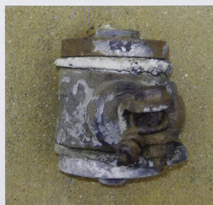
Sporvognsbeslag før istandsættelse.
